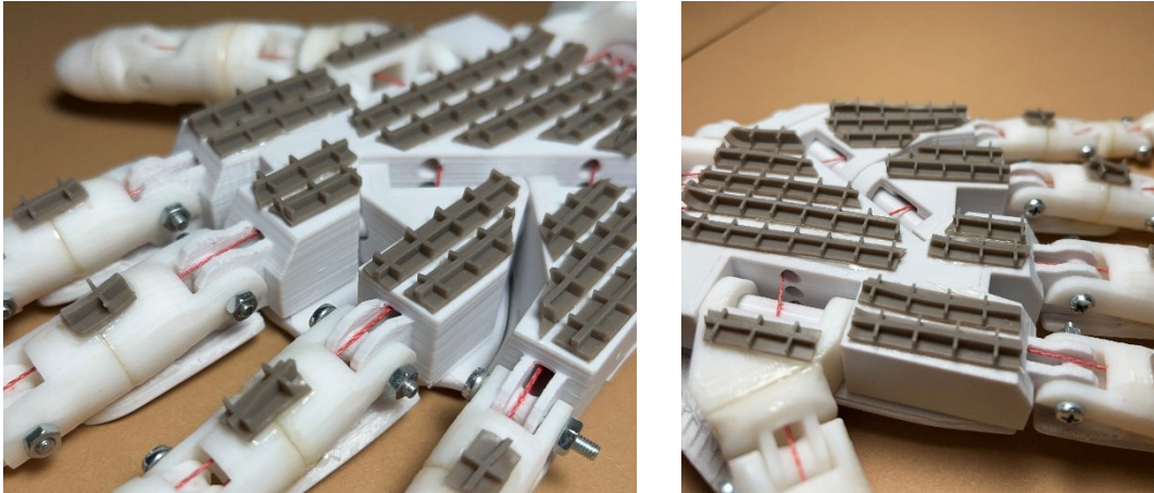
Figura 4.7: elementi in gomma per aumentare l'attrito del palmo con altri oggetti.
