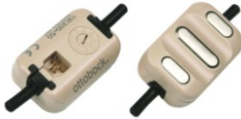
Figura 3.7: sensori sEMG capacitivi Otto Bock. Immagine presa da [15].
