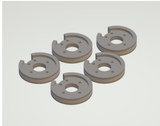
Figura 4.4: modello 3D delle pulegge di trasmissione.
