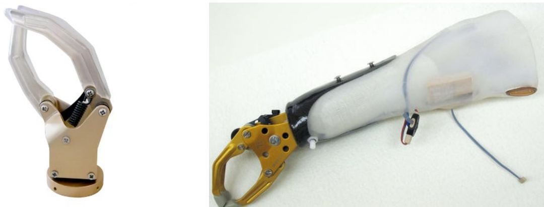
Figura 2.7: organi di presa tridigitali di protesi mioelettrica. Immagini tratte rispettivamente da www.limb-prosthetic.com/supplier-426194-upper-limb-prosthetic e da www.medicalexpo.it/prod/aesthetic-prosthetics/product-80496-507488.html consultati in data 14/12/2023.
