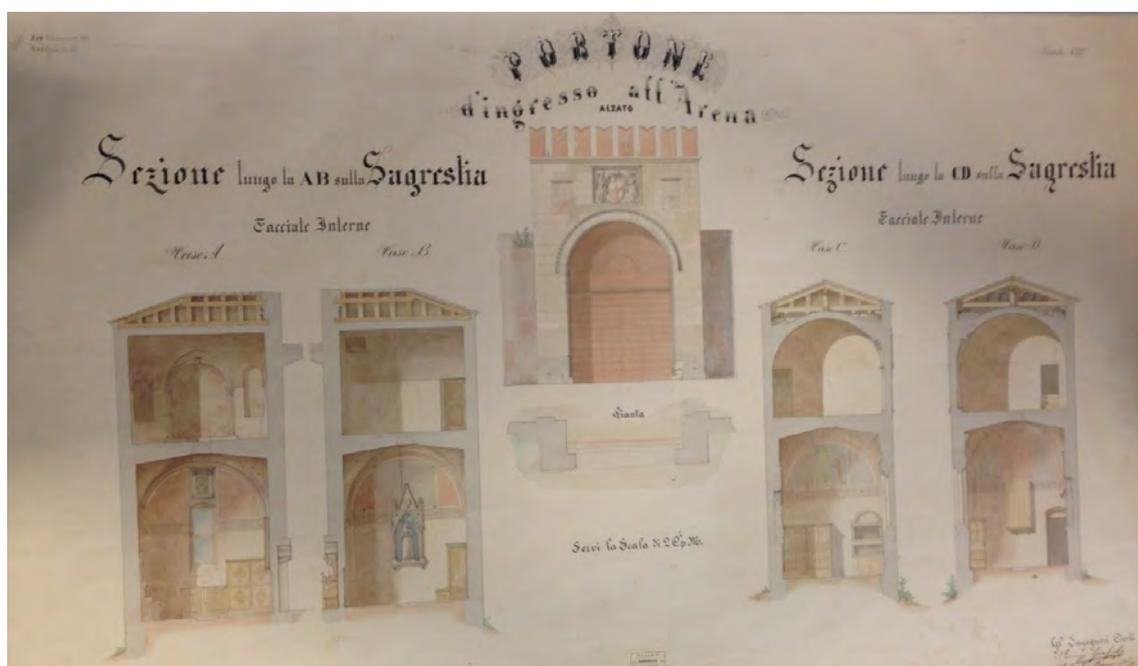
Fig. 4.8. Portone d'ingresso all'Arena, Sezione lungo AB sulla Sagrestia, sezione lungo CD sulla Sagrestia.
