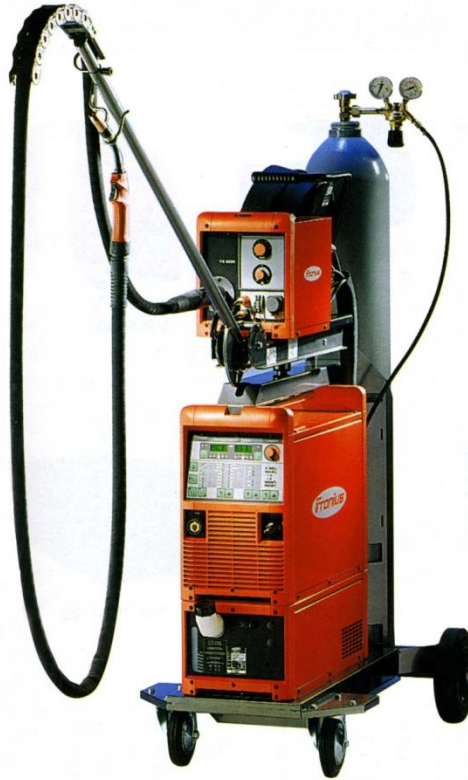
Immagine 1.6 Apparato di saldatura in gas protettivo
