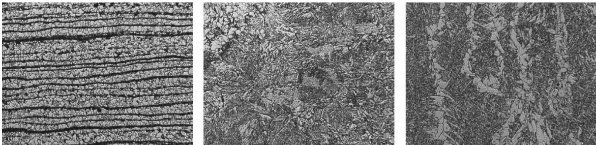
Immagine 2.7 Micrografie di un giunto saldato, in ordine: materiale base, ZTA e zona fusa
