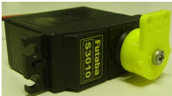
*Figura 1.6: Servo-attuatore per lo sterzo delle ruote anteriori*
