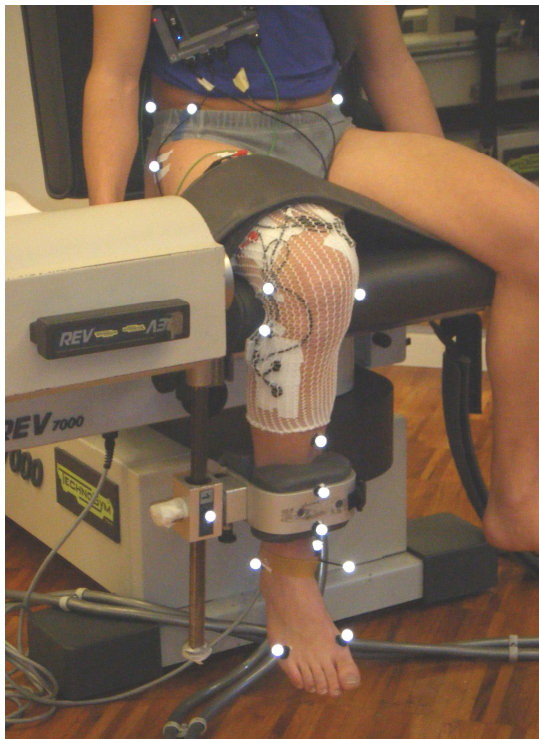
Figura 6.11. Posizionamento dei marcatori su PT seduto sulla macchina e particolare del posizionamento dei marker sulla cavigliera per la derivazione dell'esatto punto di applicazione della forza di reazione.
