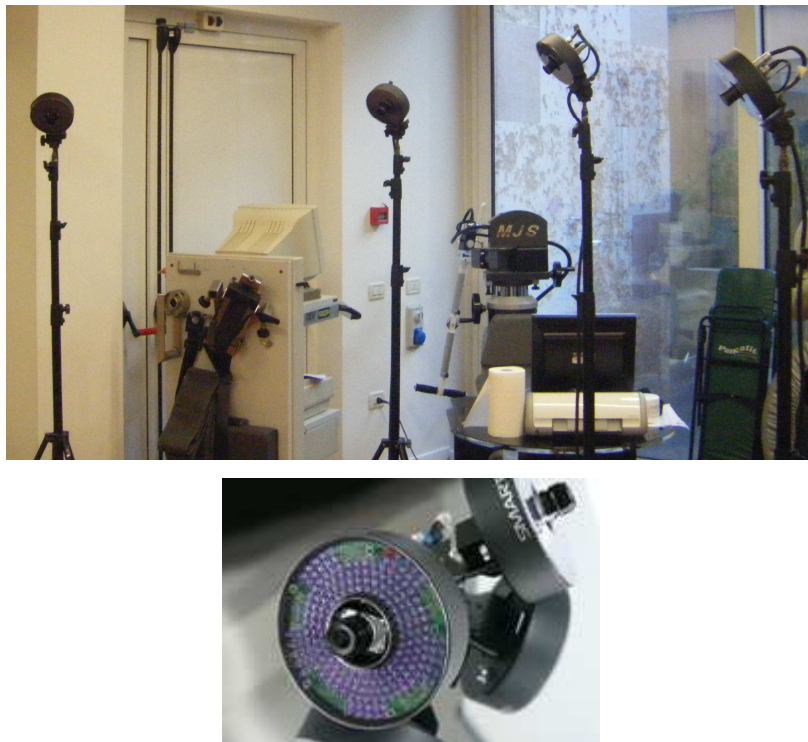
Figura 4.2. Disposizione delle telecamere attorno alla macchina isocinetica e particolare di una telecamera a raggi infrarossi.
