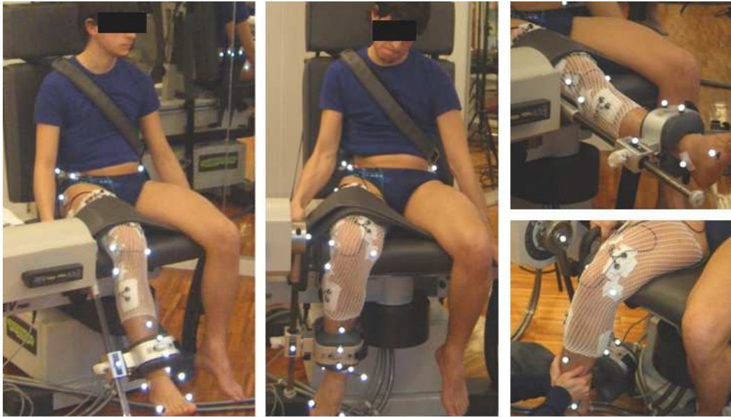
Figura 5.6. Varie fasi di una prova isocinetica e prove in isometria sulla macchina e manuali effettuate su FZ.
