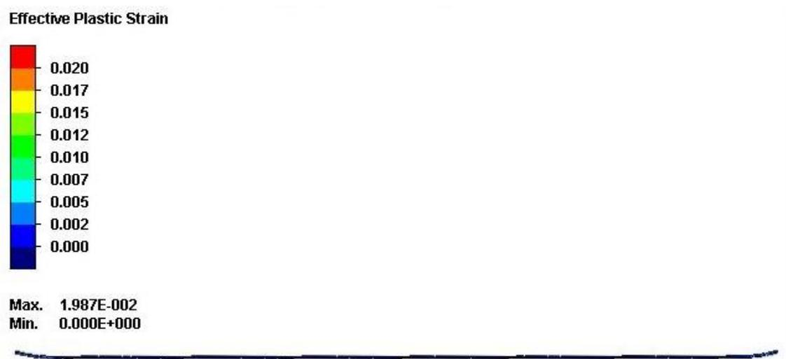
**Figura 42. Campo delle deformazioni equivalenti a fine rilascio delle attrezzature (intera lamiera) \_ Simulazione G.**
