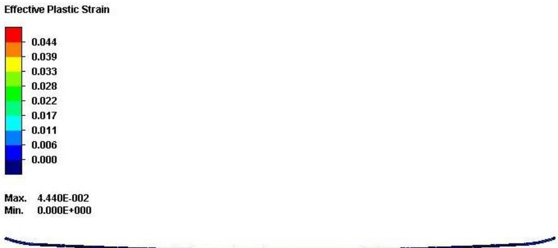
**Figura 63. Campo delle deformazioni equivalenti a fine rilascio delle attrezzature (intera lamiera) \_ Simulazione N.**
