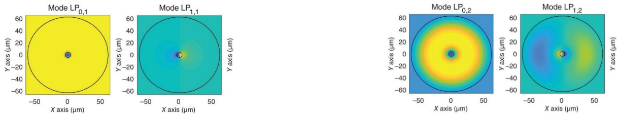
Figura 2.5: Componente del campo E_x delle modalità LP in una fibra ottica monomodale
