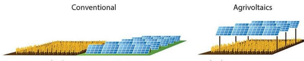
Figura 3a: Impianto fotovoltaico tradizionale a sx e impianto agrivoltaico a dx
