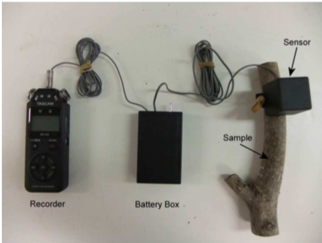
Figura 2.4: esempio di applicazione sul tronchetto in esame del sensore collegato al registratore.
