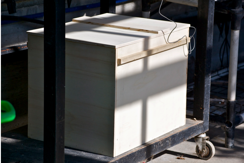
Figura 2.5: scatola di legno insonorizzata utilizzata per le registrazioni.
