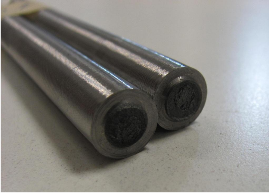
Fig. D.58: sezione di rottura del provino pos. 4_2.
