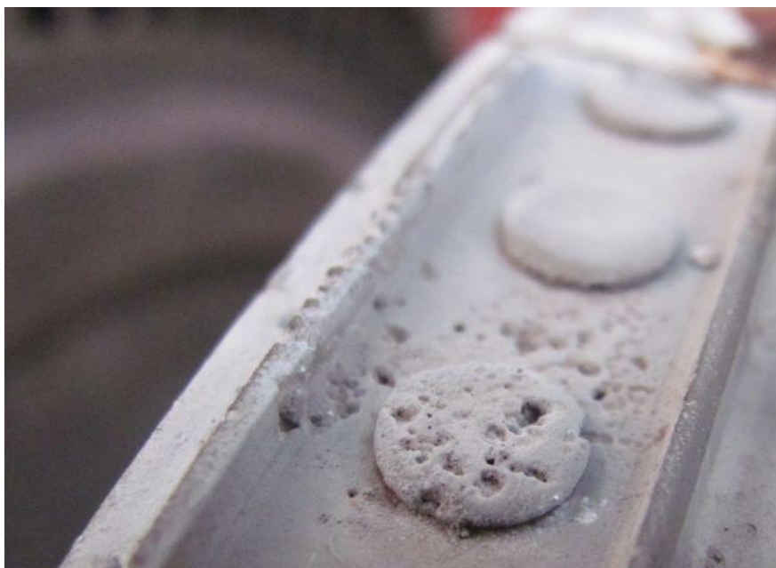
Fig. 5.1: esempio di cavità da erosione sulla testa di un piolo ribadito e sul disco di bendaggio.
