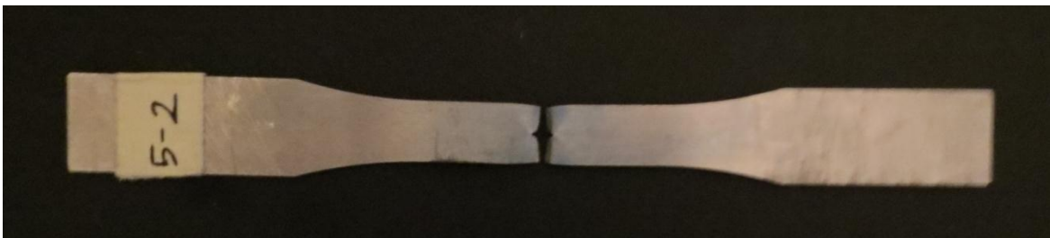
Fig. D.68: provino pos. 5_2 dopo la rottura.
