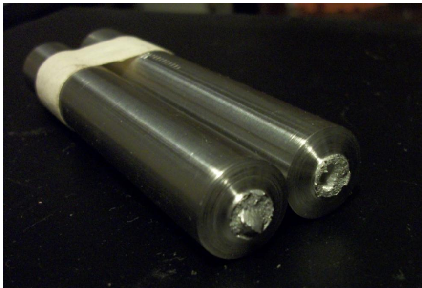
Fig. E.4: sezione di rottura del provino tipologia 1_1.
