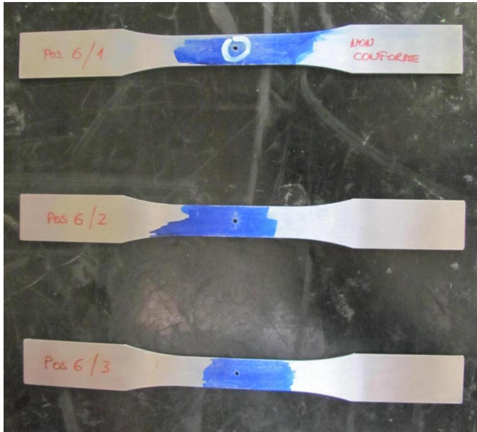
Fig. 7.12: provini della posizione 6, testati sulla macchina di trazione Schenck (il provino n° 1 non risulta essere conforme alle specifiche geometriche richieste).
