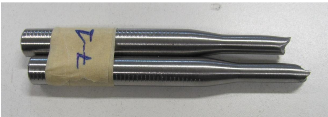
Fig. D.88: provino pos. 7_1 dopo la rottura.
