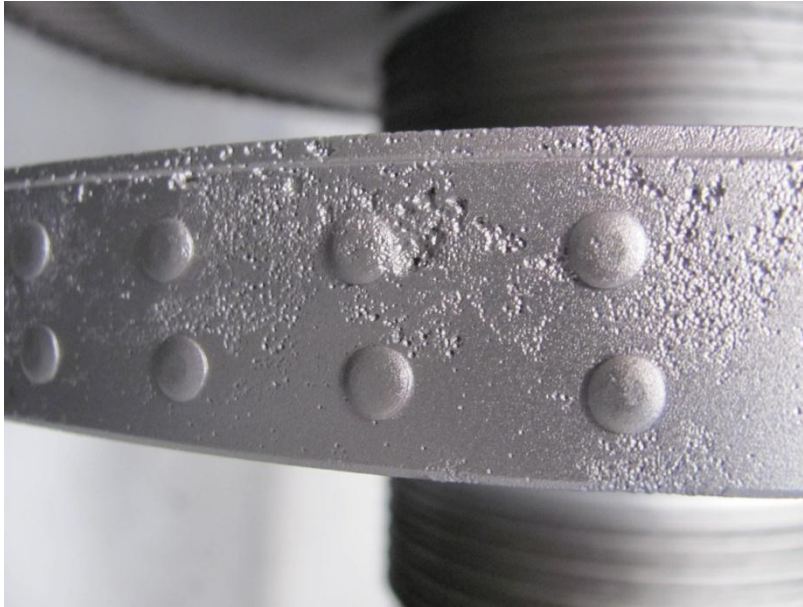
Fig. I.2: difetti di erosione del vapore sul bendaggio e sui pioli della turbina revisionata dall'Azienda De Pretto.
