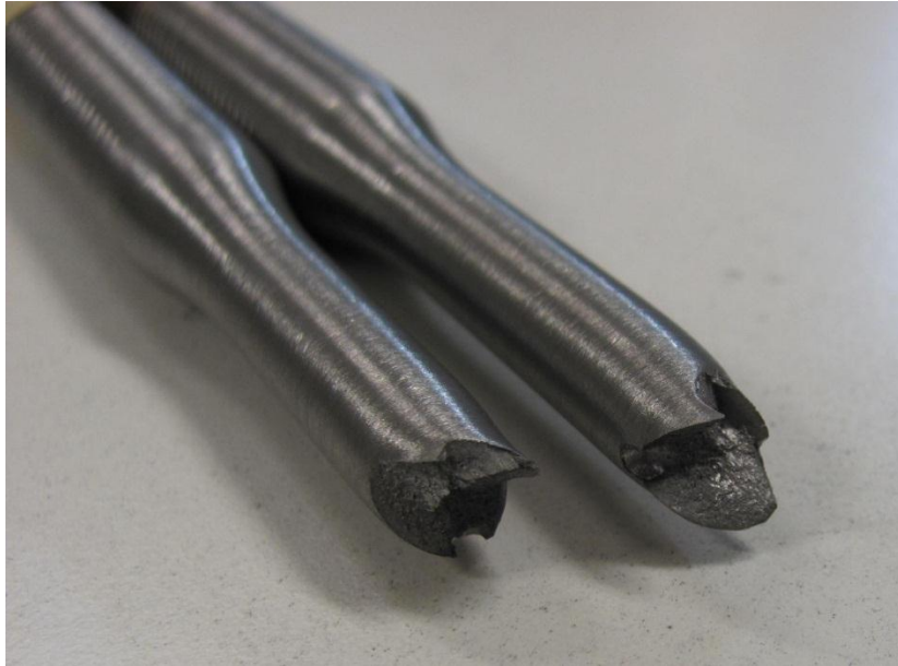
Fig. D.95: sezione di rottura del provino pos. 7_3.
