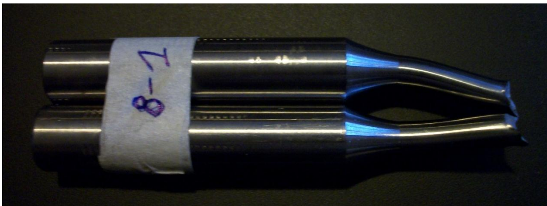
Fig. D.100: provino pos. 8_1 dopo la rottura.
