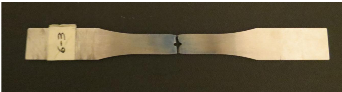
Fig. D.81: provino pos. 6_3 dopo la rottura.
