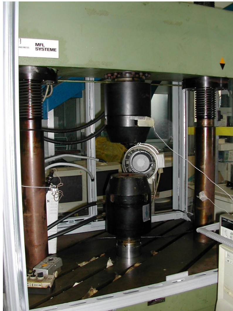
Fig. 6.3: macchina di trazione utilizzata nelle prove (MFL system).
