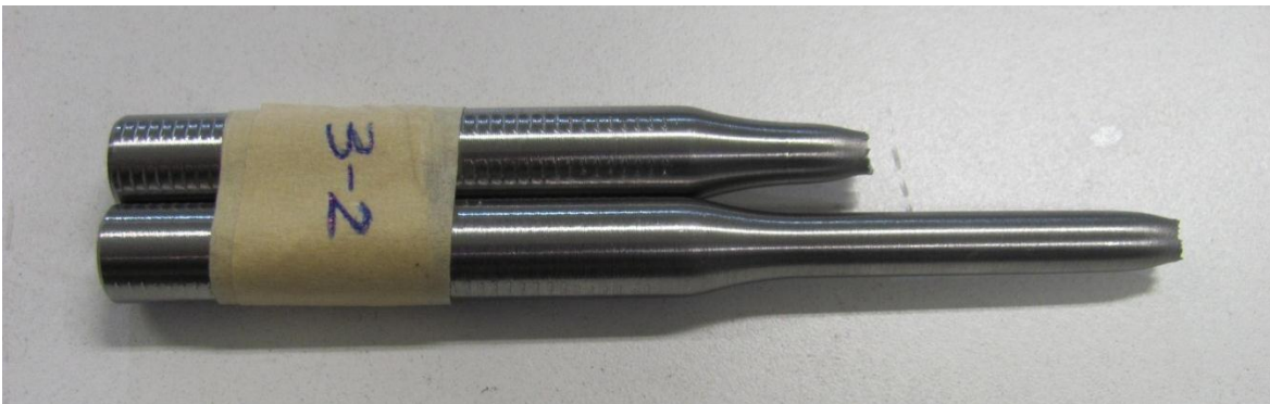
Fig. D.38: provino pos. 3_2 dopo la rottura.
