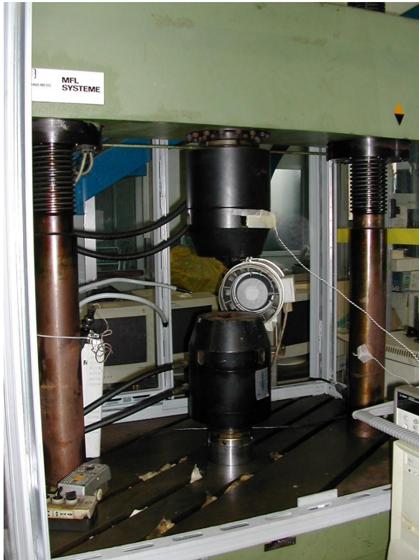
Fig. 7.21: macchina di trazione utilizzata per le prove sui provini pos. 8 (MFL).
