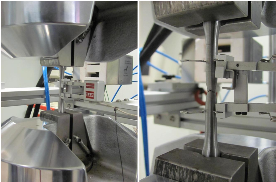
Fig. 7.16: primo provino testato della posizione 3, con applicato l'estensometro (a sinistra) e dopo rottura avvenuta (a destra).
