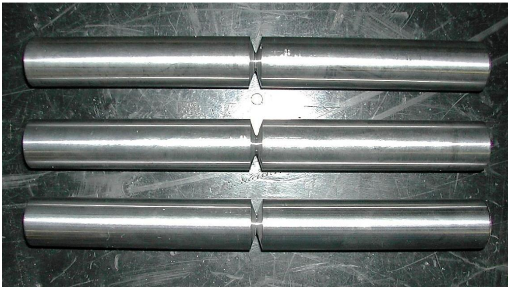
Fig. 8.7: provini della tipologia 2, testati sulla macchina di trazione MFL.
