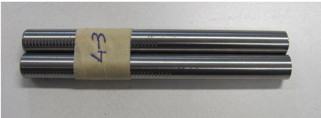
Fig. D.60: provino pos. 4_3 dopo la rottura.
