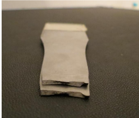
Fig. D.9: sezione di rottura del provino pos. 1_2.
