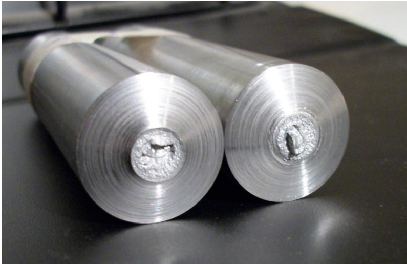
Fig. E.21: sezione di rottura del provino tipologia 2_3.
