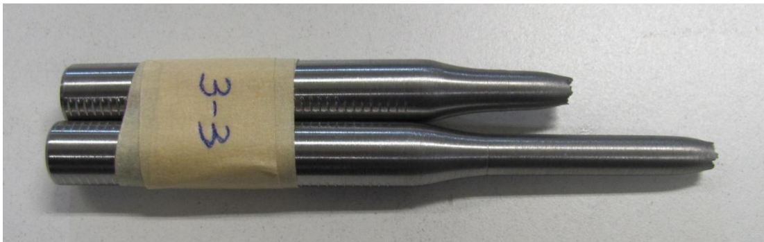
Fig. D.45: provino pos. 3_3 dopo la rottura.
