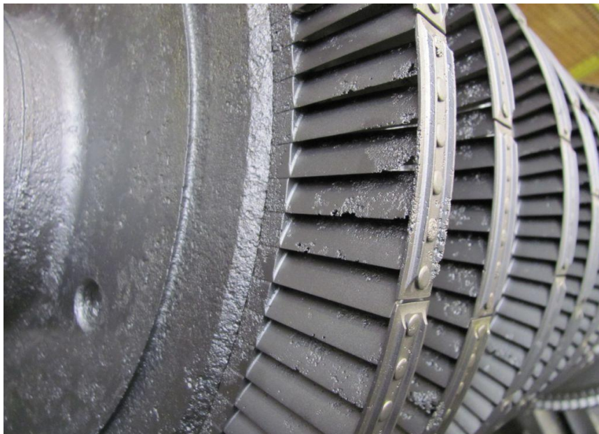
Fig. 5.2: esempio di effetti dell'erosione diffusa del vapore sui componenti turbina.
