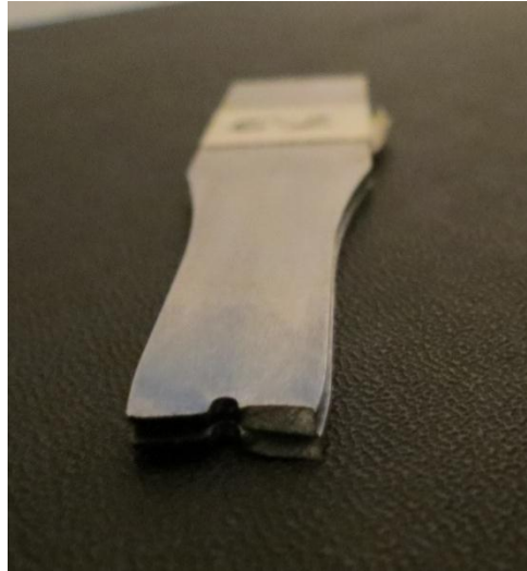
Fig. D.80: sezione di rottura del provino pos. 6_2.
