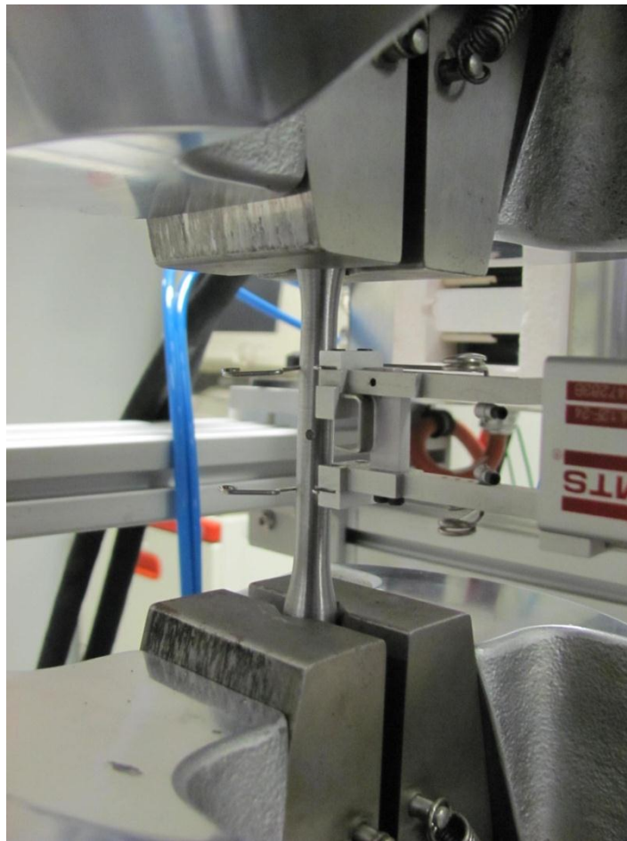
Fig. 7.20: primo provino testato della posizione 7 con applicato l'estensometro.
