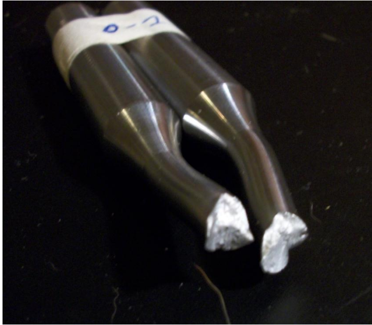
Fig. D.101: sezione di rottura del provino pos. 8_1.
