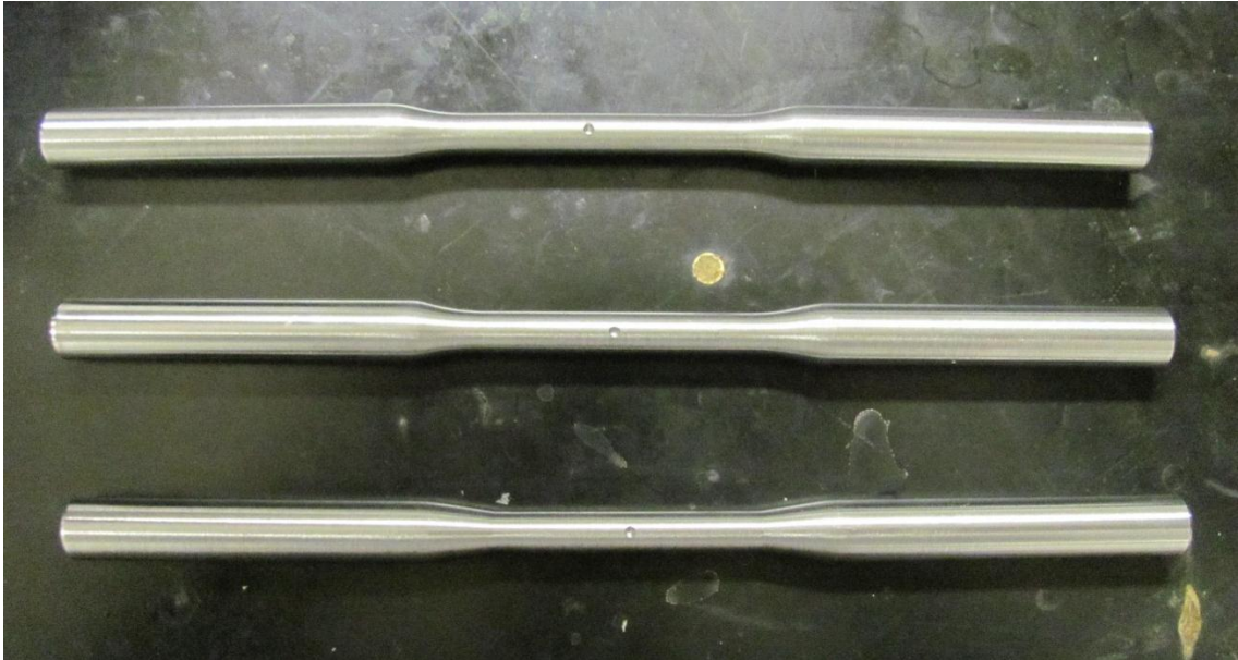
Fig. 7.19: provini della posizione 7, testati sulla macchina di trazione MTS.
