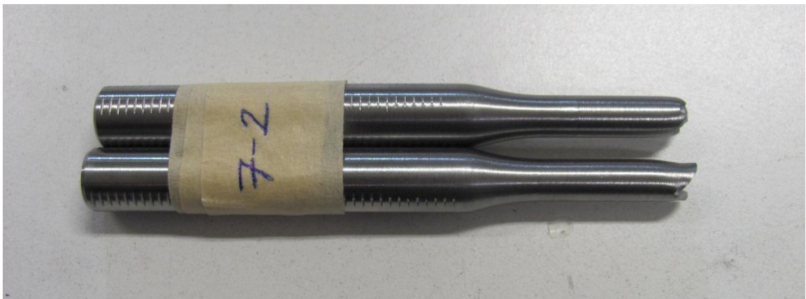
Fig. D.91: provino pos. 7_2 dopo la rottura.
