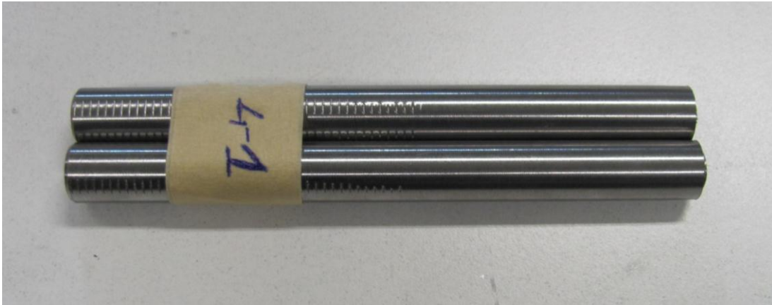
Fig. D.54: provino pos. 4_1 dopo la rottura.
