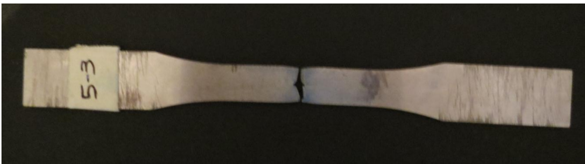
Fig. D.71: provino pos. 5_3 dopo la rottura.
