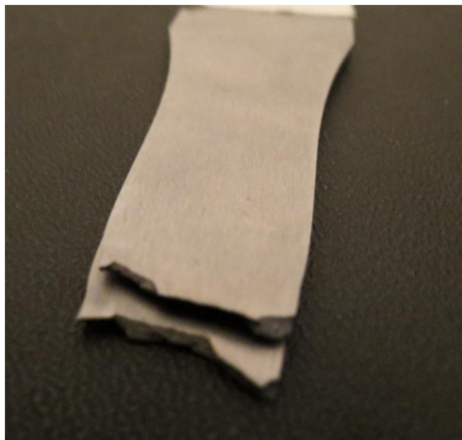
Fig. D.4: sezione di rottura del provino pos. 1_1.
