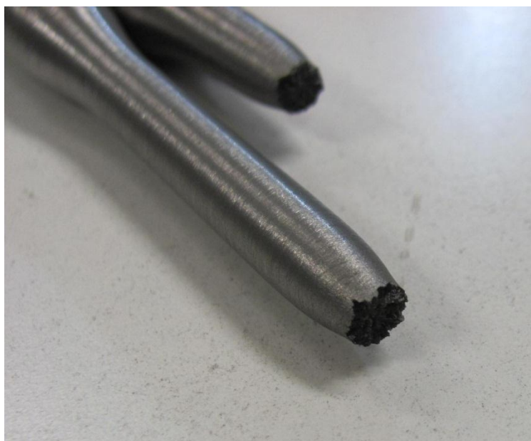
Fig. D.46: sezione di rottura del provino pos. 3_3.
