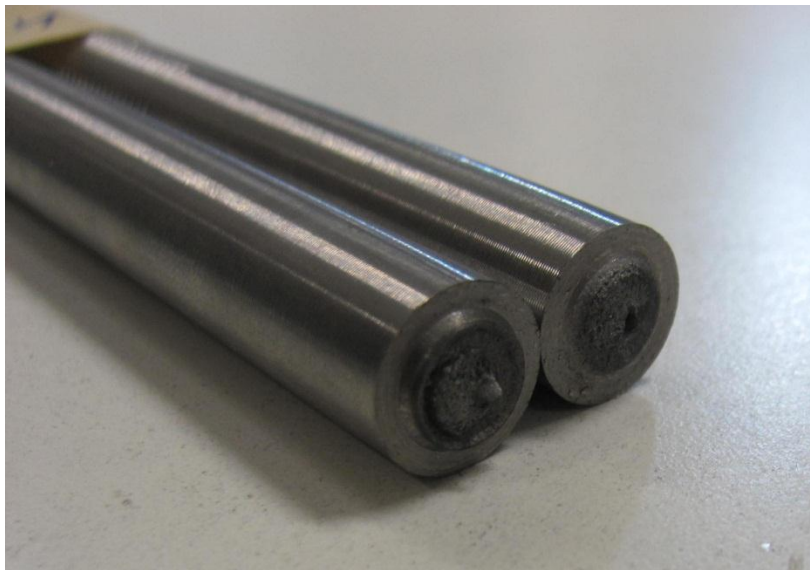
Fig. D.55: sezione di rottura del provino pos. 4_1.
