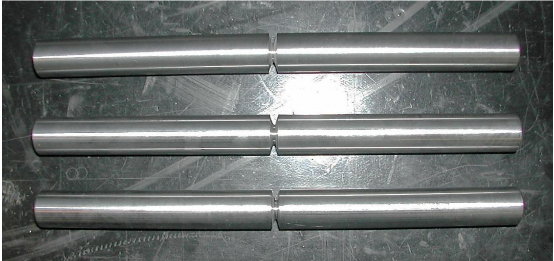
Fig. 8.5: provini della tipologia 1, testati sulla macchina di trazione MFL.
