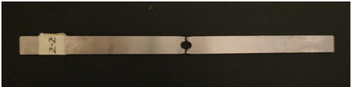
Fig. D.23: provino pos. 2_2 dopo la rottura.
