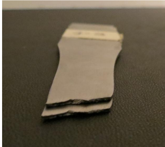
Fig. D.14: sezione di rottura del provino pos. 1_3.
