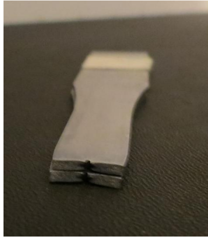
Fig. D.69: sezione di rottura del provino pos. 5_2.
