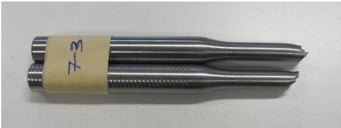
Fig. D.94: provino pos. 7_3 dopo la rottura.
