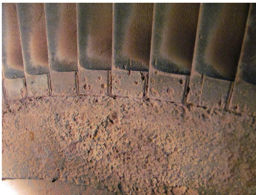
Fig. 5.3: esempio di effetti dell'erosione diffusa su un disco turbina.
