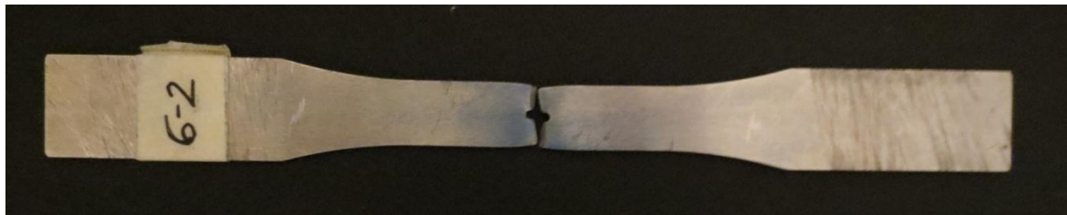
Fig. D.79: provino pos. 6_2 dopo la rottura.
