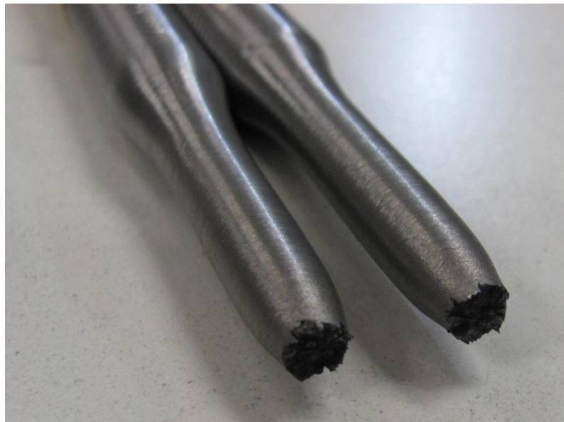
Fig. D.32: sezione di rottura del provino pos. 3_1.
