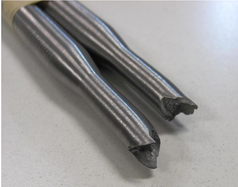
Fig. D.89: sezione di rottura del provino pos. 7_1.
