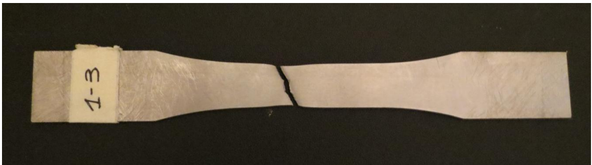
Fig. D.13: provino pos. 1_3 dopo la rottura.
