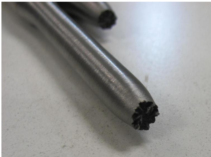
Fig. D.39: sezione di rottura del provino pos. 3_2.
