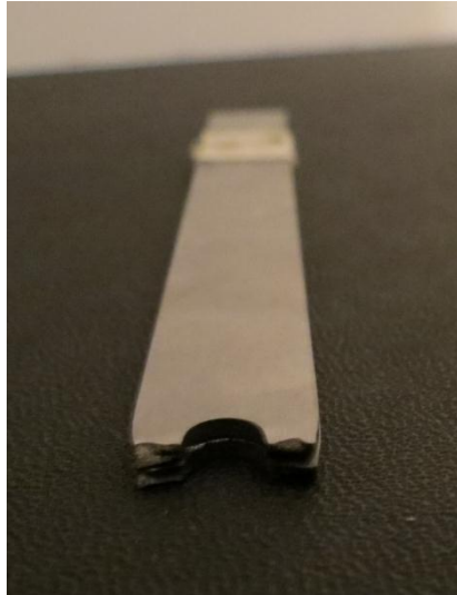
Fig. D.27: sezione di rottura del provino pos. 2_3.
