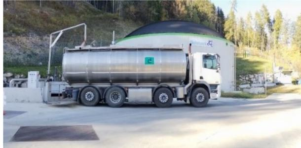
*Figura 3.2.4: Fase di carico del digestato liquido da parte del camion*
