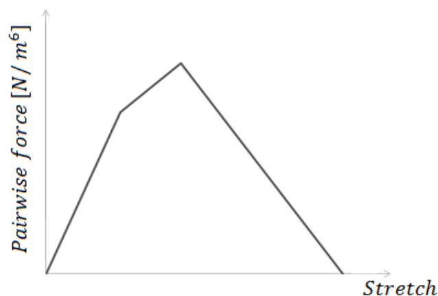
Fig 4.55 Modello trilineare k_r=4 , k_s=2.2 , k_f=1.3
