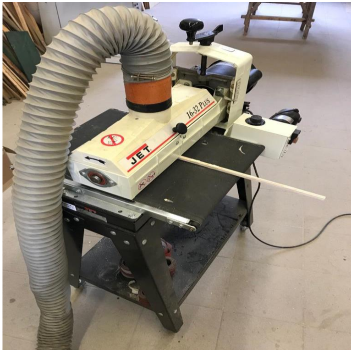
Foto 4.3 Levigatrice elettrica utilizzata per levigare le carote
