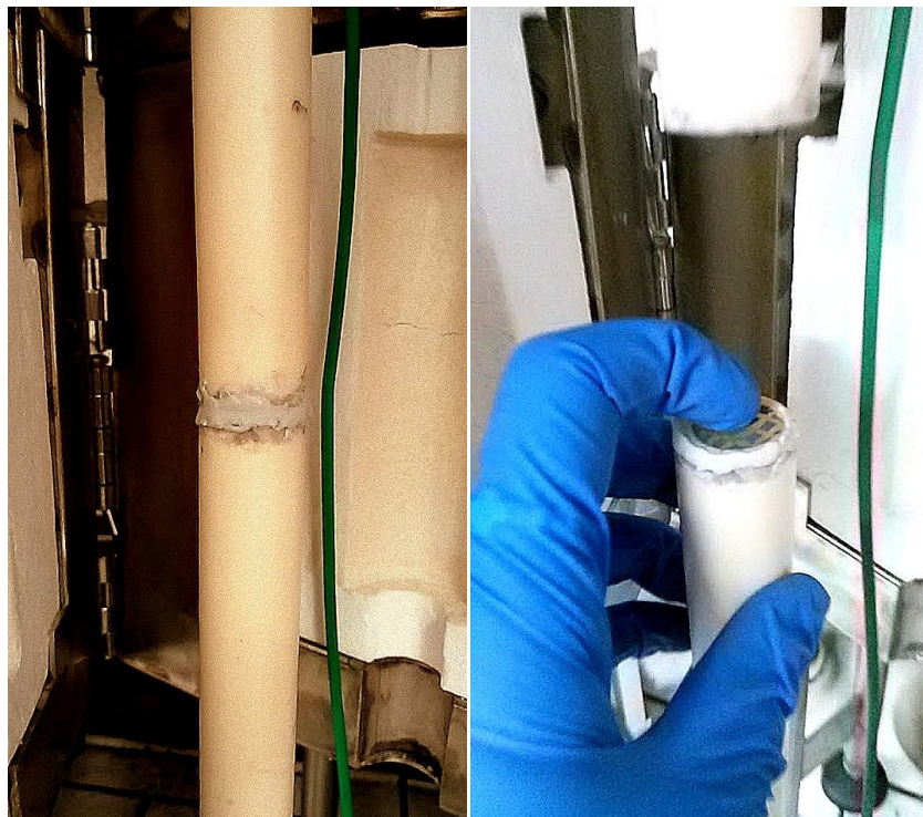
Figura 6.7 a sinistra: tubi di allumina sigillati con ceramabond; a destra: cella Ni-CGO/CGO/Ni-CGO in fase di sigillatura
