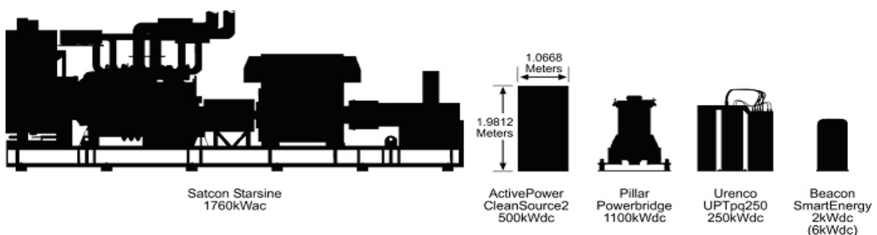
Figura 26 Profili delle dimensioni di vari volani atti all'accumulo energetico
