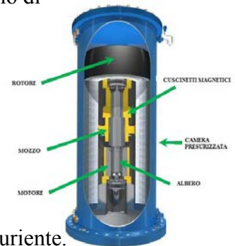
Figura 25 I componenti della struttura di un volano
