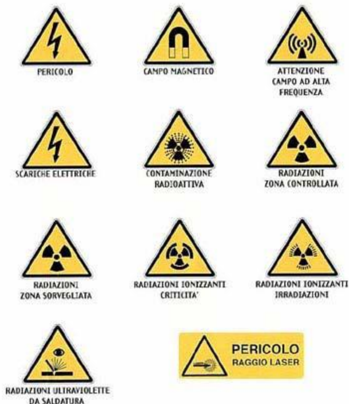
Fig. 3.1 Segnalazioni di avvertimento – pericolo
