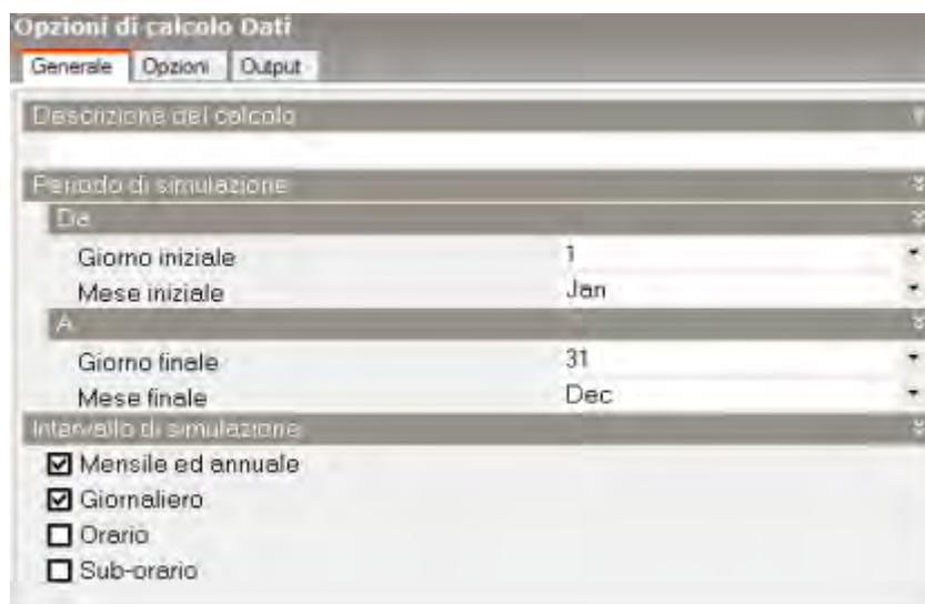
**Figura 6.2.2.2** Design Builder, esempio di impostazione della simulazione
