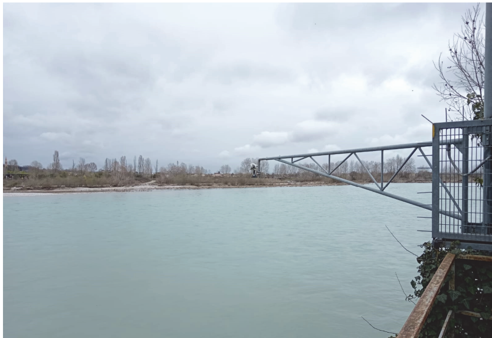
Figura 8: Piena del fiume Piave registrata in data 02/04/2024, con al centro lo strumento sonar per il rilevamento del livello del fiume
