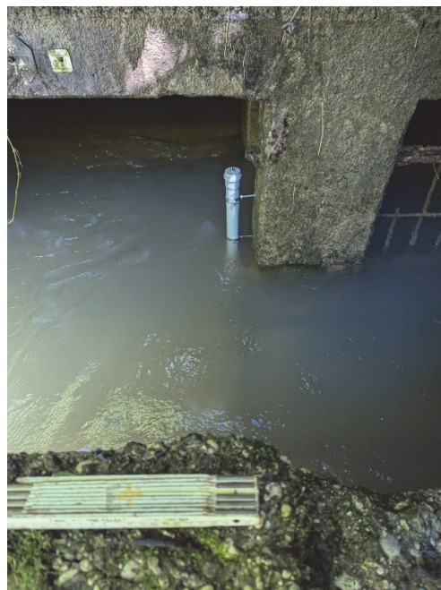
Figura 16: CTD-Diver della sorgente Forame racchiuso nel tubo di protezione.
