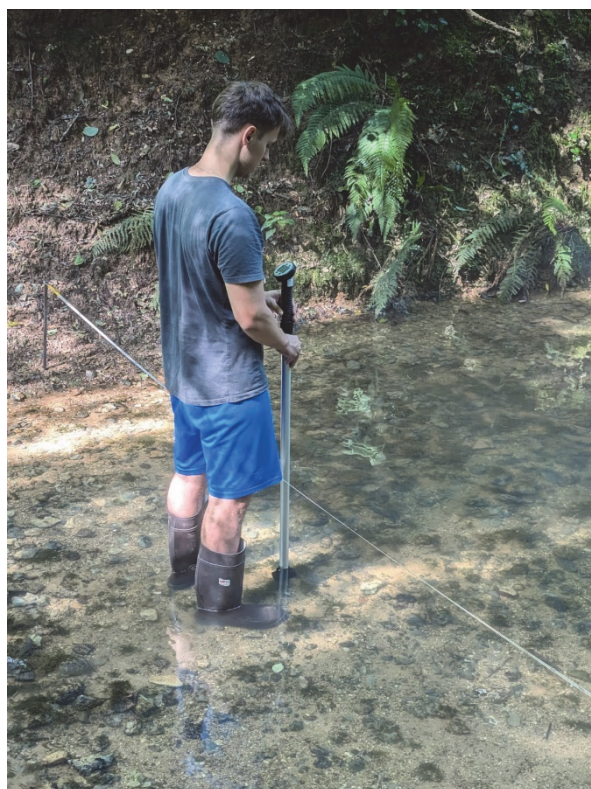
Figura 24: Misurazione della velocità del flusso mediante mulinello idrometrico.
