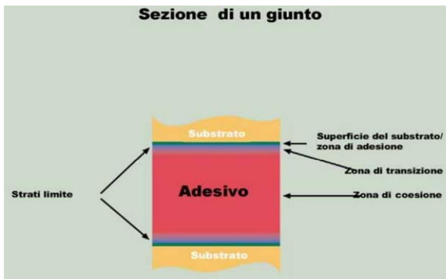
Figura 1: sezione di un giunto incollato
