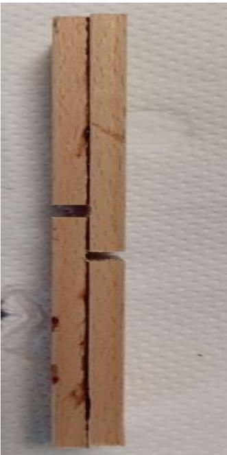
Figura 16: campione preparato per il test a trazione
