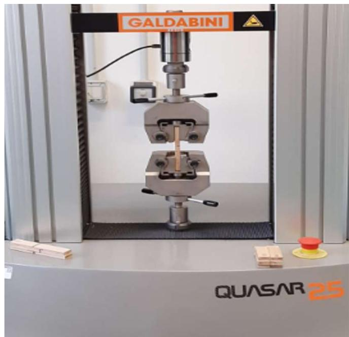
Figura 17: macchinario per eseguire i test meccanici GALDABINI QUASAR 25
