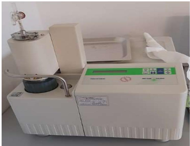
Figura 20: strumentazione Mettler Toledo TMA/SDTA840 (Mettler Toledo, Columbus, OH, USA)
