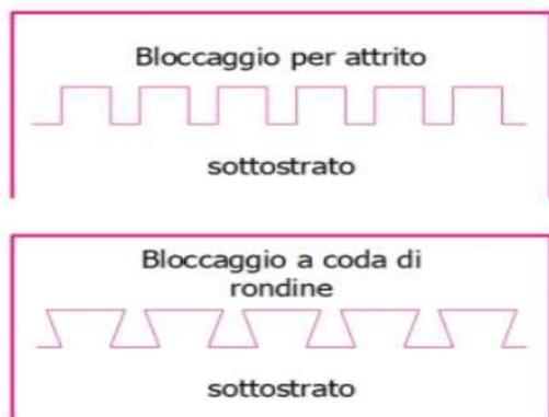
Figura 3: diagramma schematico dei meccanismi di interlocking meccanico
