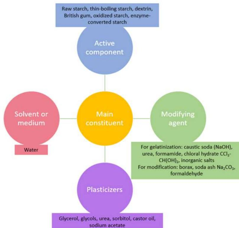
Figura 6: i quattro principali costituenti degli adesivi a base di amido
