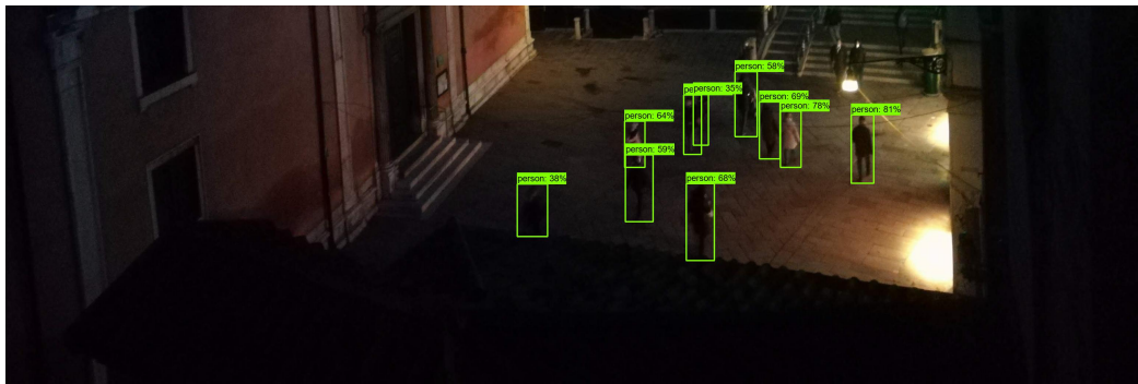
Figura B.7: Fotografia scattata di notte con mancato riconoscimento di una coppia di persone.
