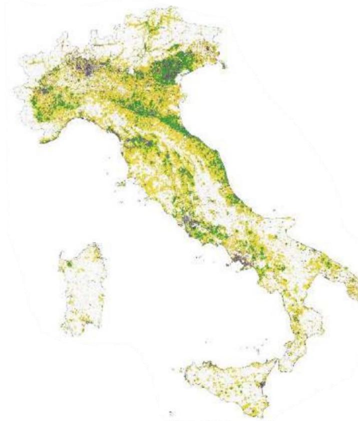
Densità di fabbisogno di riscaldamento e ACS residenziale 2020 [kWh/m 2 sezione ]
