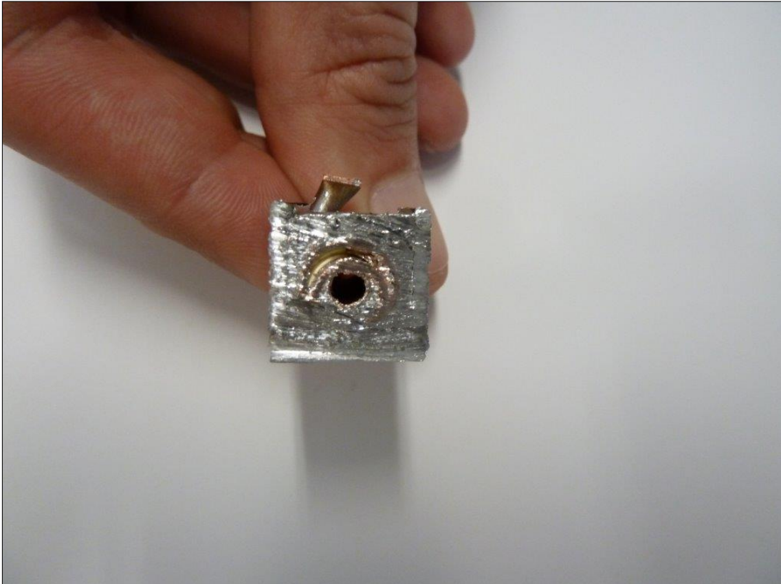
Figura 3.11: Sezione del bagno di colata, con l'avvolgimento a spire opportunamente distanziate e il microfin all'interno.
