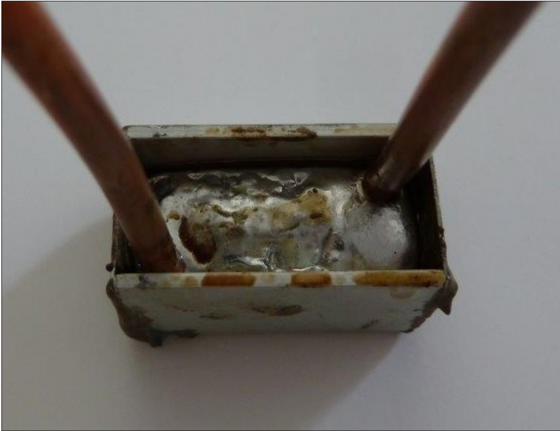
Figura 3.6: Vista superiore del bagno di colata.
