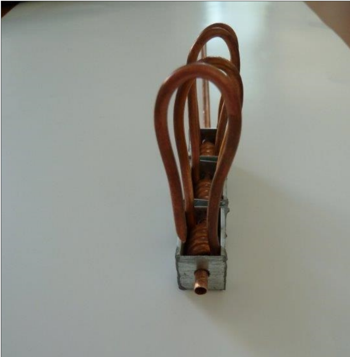
Figura 3.14: Vista laterale della sezione di prova sperimentale, prima della colata dello stagno fuso.
