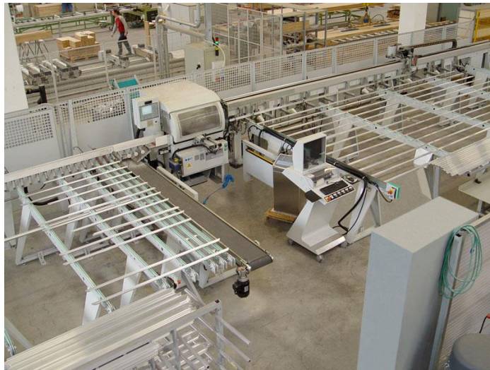
Figura n.1.9: macchina per il taglio dei profili, tratta da www.uniform.it
