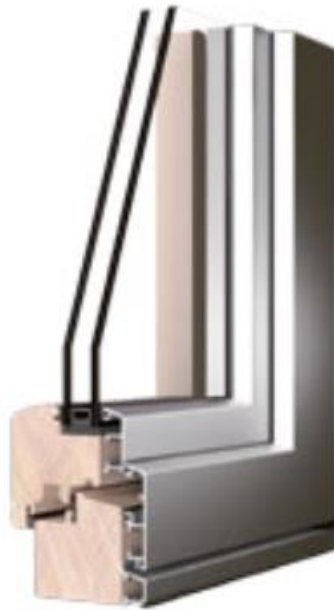
Figura n.1.3: Spaccato di una finestra in legno-alluminio, tratta da www.uniform.it
