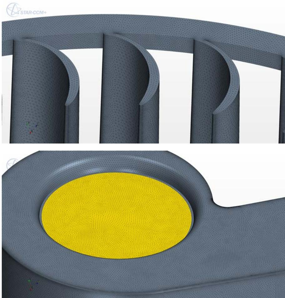
Figura 4.7: Mesh di superficie.
