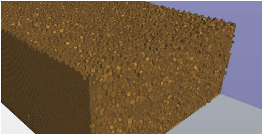
Figura 4.8: Mesh poliedrica e prism layers sul condotto di mandata.
