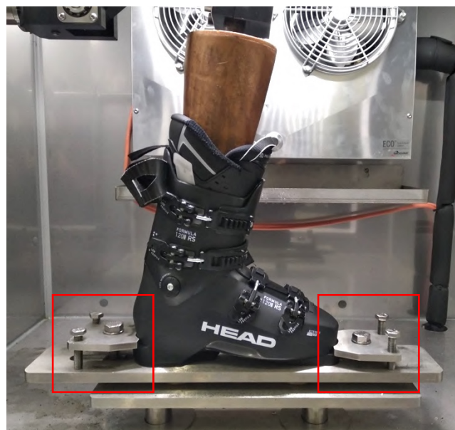
Figura 4-65: Setup condizioni di vincolo della prova dello scarpometro
