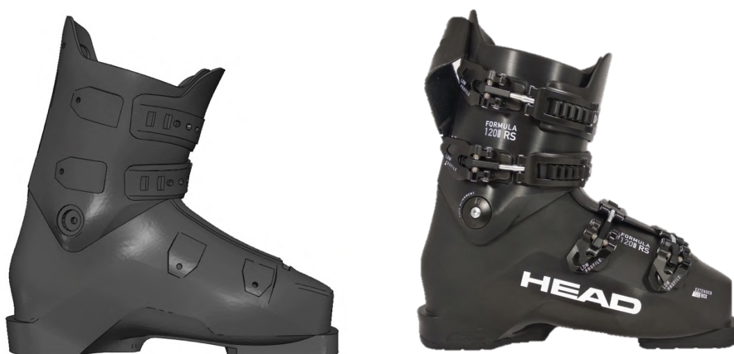
Figura 4-45: Confronto modello numerico chiuso e scarpone reale
