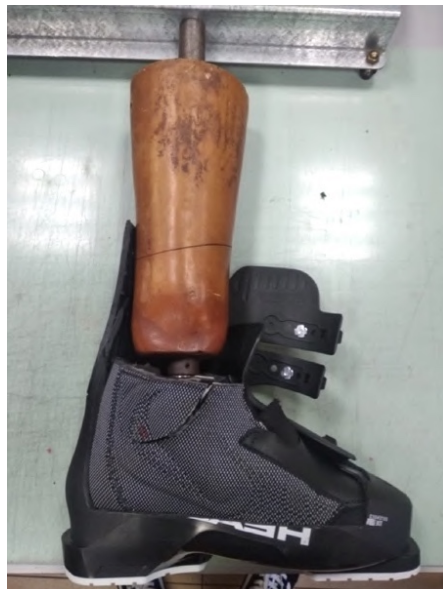
Figura 1-5: Protesi e scarpetta inseriti nello scarpone (foto solo dimostrativa per evidenziare come si posiziona la scarpetta tagliata all'interno dello scarpone, per la prova allo scarpometro verrà utilizzato uno scarpone non tagliato)
