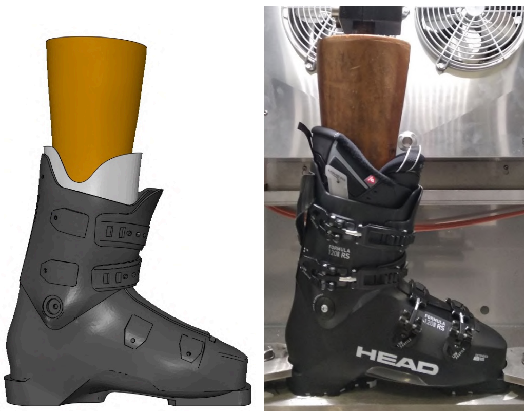
Figura 4-97: Posizione di massima spinta indietro della protesi
