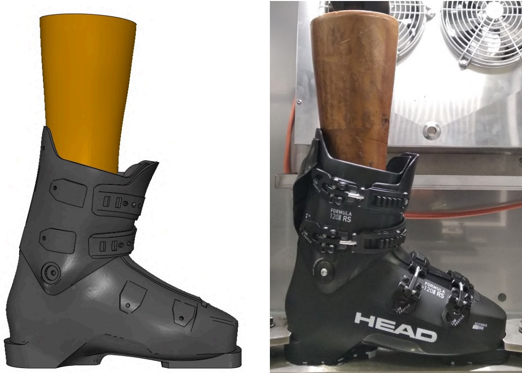
Figura 4-81: Posizione di massima spinta indietro della protesi
