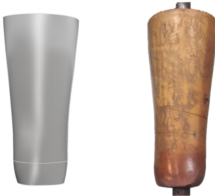
Figura 4-52: Confronto protesi realizzata con modellazione CAD tridimensionale e protesi reale
