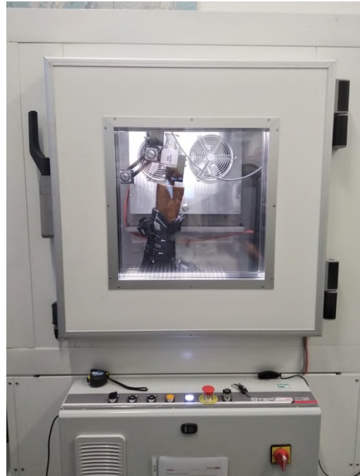
Figura 1-7: Cella che permette allo scarpometro di fissare una determinata temperatura per la prova
