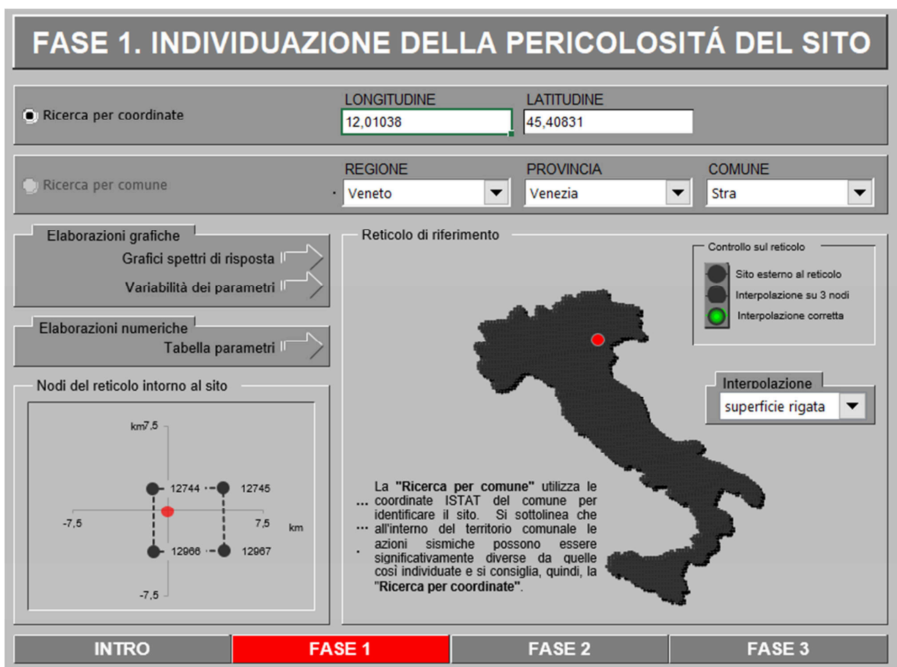
Fig. 7.17: Schermata di inquadramento del programma "Spettri di risposta" impostata per il calcolo dei parametri secondo le coordinate del complesso di Villa Pisani.
