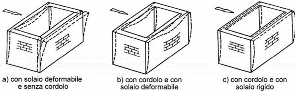
Fig. 2.2: Schemi di comportamento tipo in funzione del grado di collegamento delle pareti e degli orizzontamenti. [Fonte: Analisi e interventi strutturali su edifici in muratura secondo le NTC 2008, Modena C., 2012]
