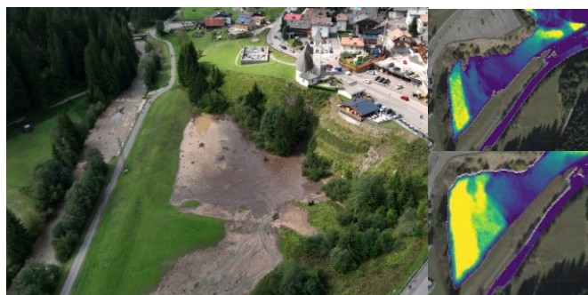
Figura 75. Confronto depositi delle colate simulate e quelli reali. Zona lungo la piana alluvionale. Simulazione 1 in alto; Simulazione 2 in basso
