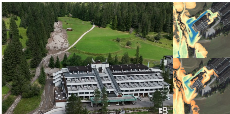
Figura 73. Confronto depositi delle colate simulate e quelli reali, nei pressi delle strutture alberghiere. Simulazione 1 in alto; Simulazione 2 in basso
