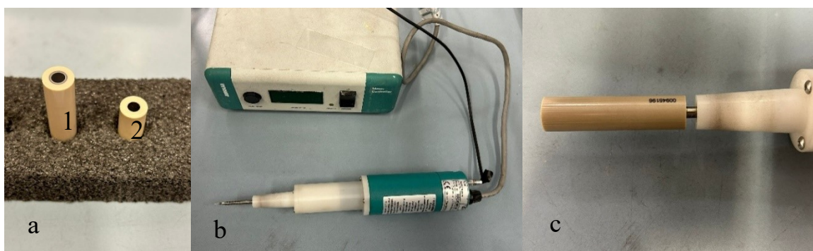
Figura 3.3: Sono riportate le immagini delle tipologie di elettrodi utilizzati (a). L'elettrodo a.1 è stato utilizzato per analisi RRDE, mentre il a.2 per nitrite stripping. In (b) viene mostrato un motore utilizzato (Autolab RRDE), connesso al controller (Autolab Motor Controller) dal cavo grigio e al potenziostato dal cavo nero. In (c) viene mostrato l'aggancio di un elettrodo alla vite del motore.
