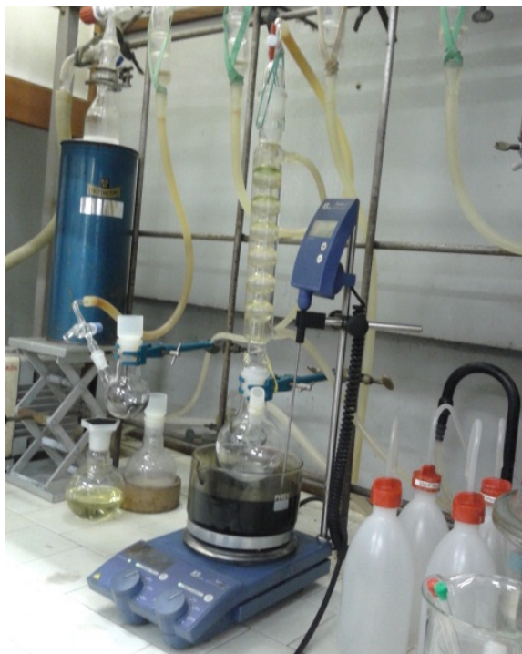
Figura 4.2: Fase di riscaldamento a riflusso (270°C) della miscela.
