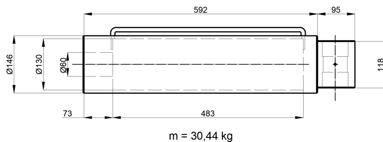
Figura 21: Camicia dei cilindri di spinta originali
