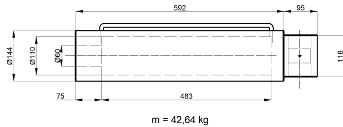
Figura 26: Camicia esterna dei cilindri di spinta rivalutata a 340 bar
