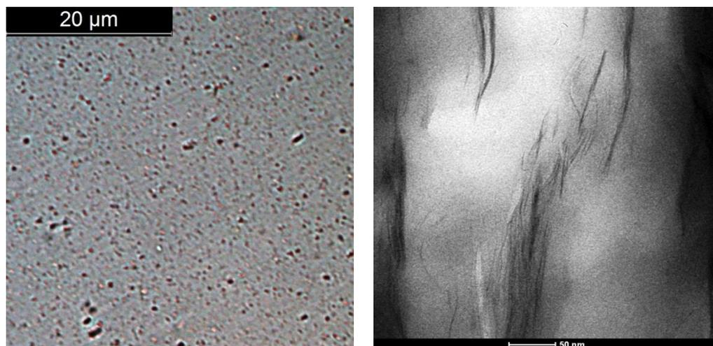
Figura 6.3. Micrografia ottica e al TEM della morfologia del nanocomposito
