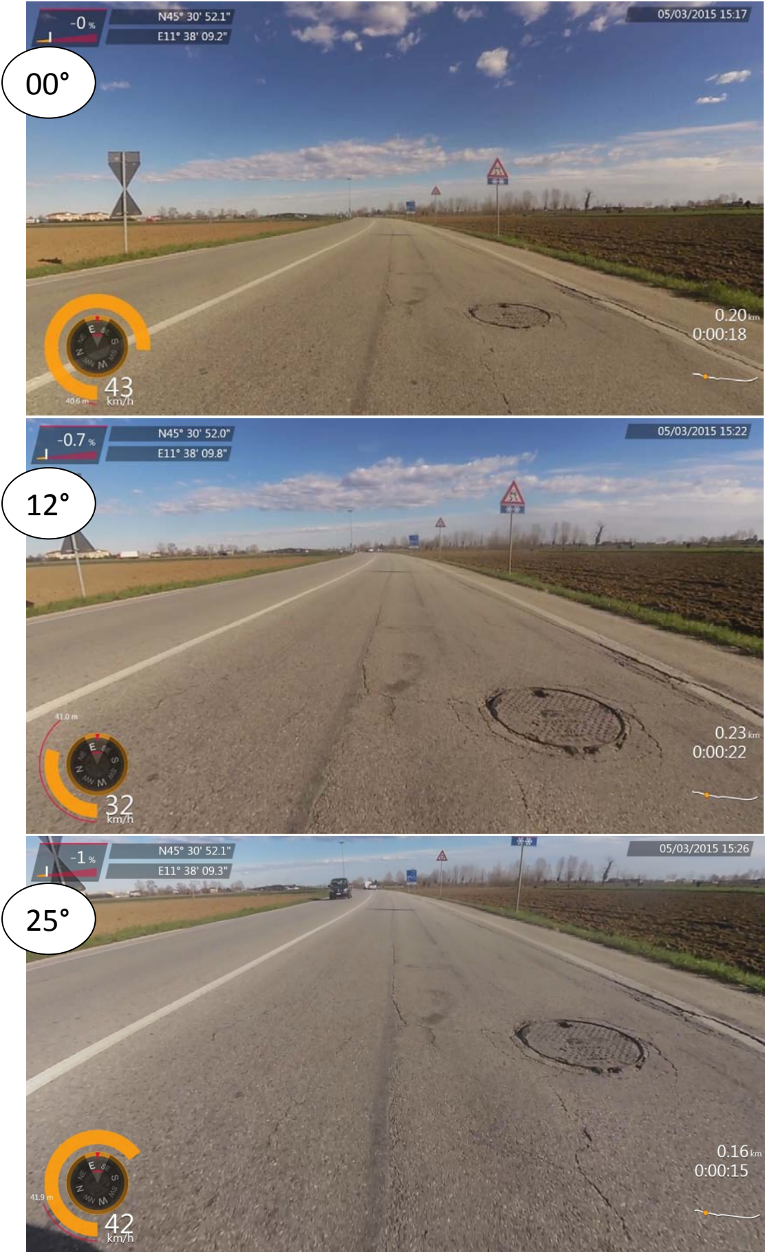
Figura 4.1 – Prova 1 inclinazione telecamera
