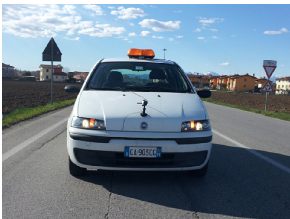
Figura 4.3 – Posizionamento telecamera sul cofano
