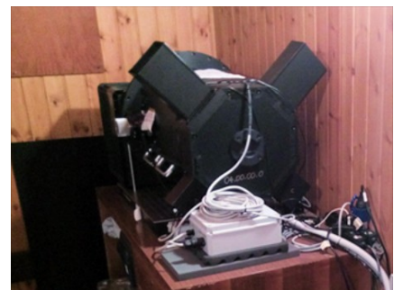
Figura 1.1: Aqueye+ montato al telescopio Copernico (sopra), Iqueye alimentato da una fibra ottica nella cupola del telescopio Galileo ad Asiago (sotto).
