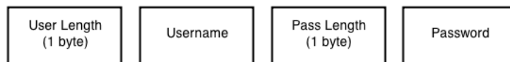
Figura 3.6: Payload relativo alla richiesta di login. Le credenziali del tecnico vengono comunicate al server che ne verifica la correttezza.
