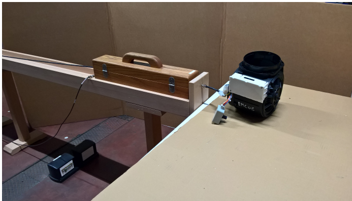
Figura 5.4 Setup utilizzato per le misure di potenza di disturbo
