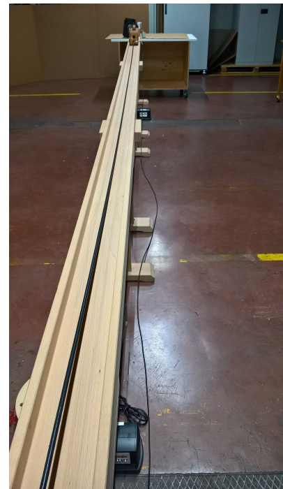
Figura 5.4 Setup utilizzato per le misure di potenza di disturbo
