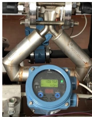
Figura 4.1.1. Misuratore di portata di massa ad effetto Coriolis
