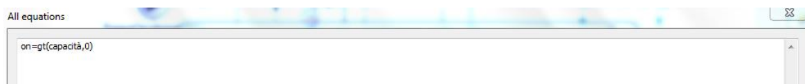
Figura 5.28: Equazione che associa l'accensione della pompa del primario all'accensione della pompa di calore
