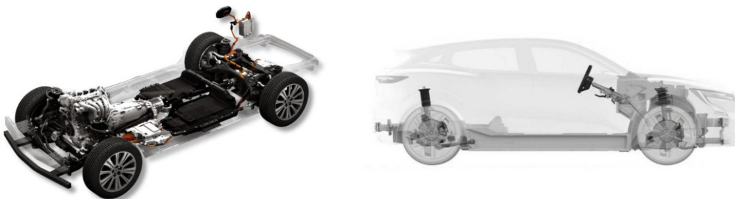
A sx, piattaforma di un’auto termica. A dx, piattaforma di un’auto elettrica
