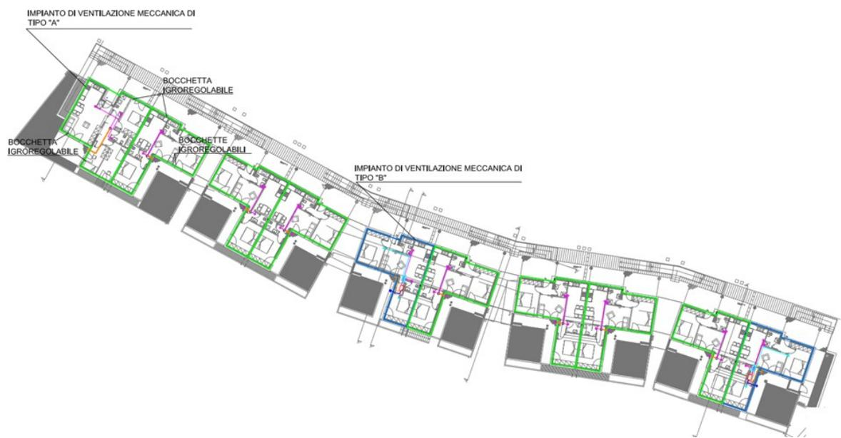
**Figura 6 - Disposizione impianti di ventilazione meccanica al piano terra dei singoli Blocchi**
