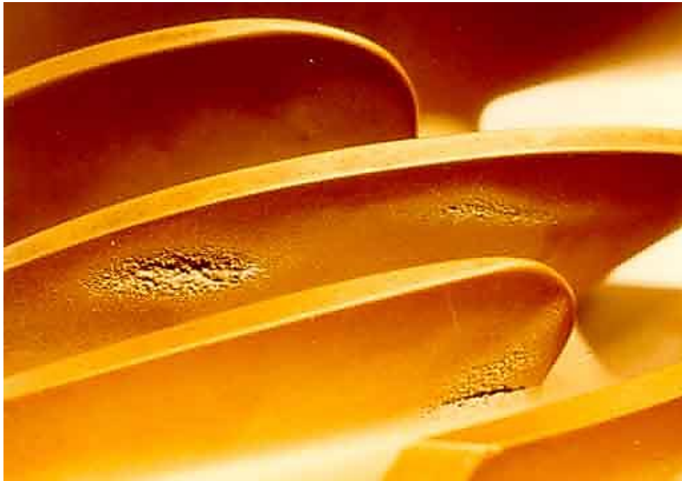
Figura 4-10: Foto dei tipici danni da cavitazione su di una pala di una pompa a flusso misto
