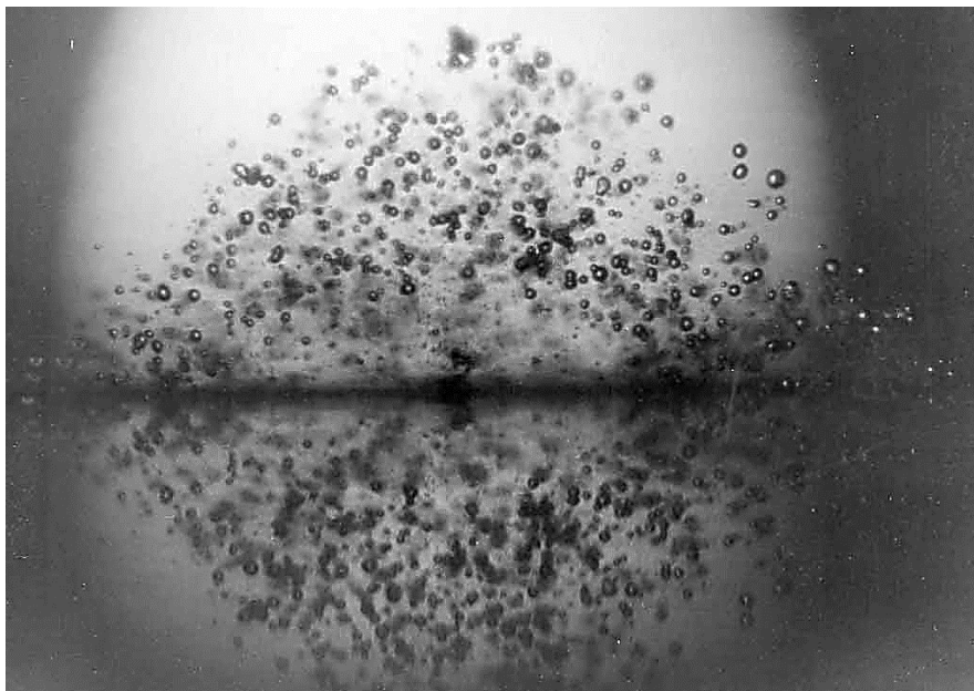
Figura 4-12: Fotografia di una nube di bolle da cavitazione generata per via acustica (Plesset, Ellis-1955)
