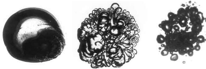
Figura 4-3: Fotografia di una bolla d'aria nella glicerina prima (a sinistra) e dopo (al centro) il collasso ed il contraccolpo. A destra si osserva una nuvola causata da cicli di collasso e contraccolpi (Frost e Sturtevant-1986)
