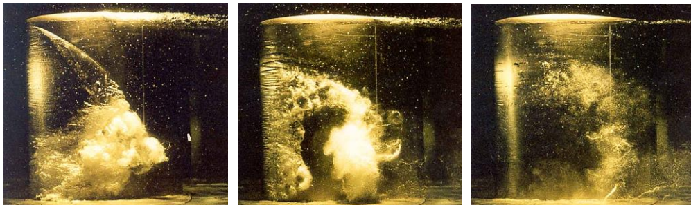
Figura 5-9: Tre scatti fotografici che illustrano la formazione, separazione e collasso di una nuvola da cavitazione su di una superficie di un profilo aerodinamico (0.152 m di corda) oscillante con una frequenza di 5.8 Hz e un angolo di incidenza di 5°. Il flusso è da sinistra a destra; la velocità del flusso è di 7.5 m/s e il valore medio del numero di cavitazione è 1.1. E.McKenney
