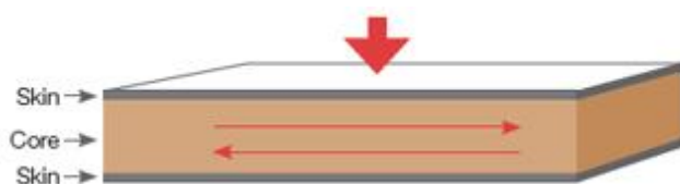
(fig. 1.1 – Composizione del sandwich)
