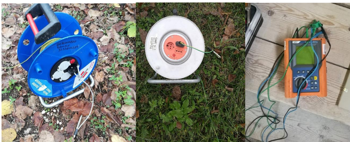
(fig. 10.7 – dispersori di tensione e corrente con relativo strumento per la misurazione)
