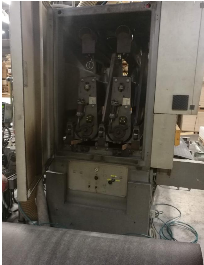
(fig. 9.2 - macchinario per la levigatura dei pannelli con relativo rullo di carta vetrata)
