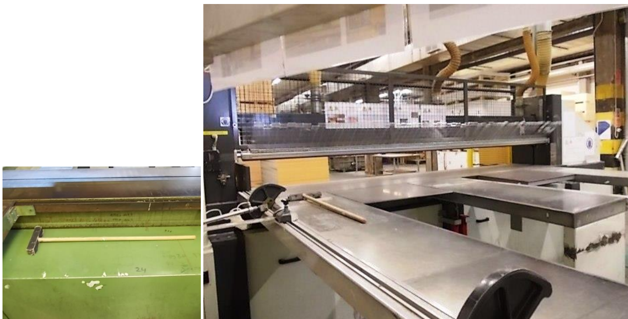
(fig. 6.3 – a sinistra l'attrezzo spingi pannelli, a destra la sezionatrice Magic)
