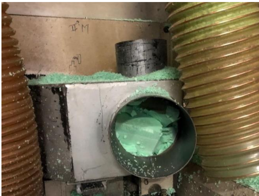
(fig. 6.5 – bocchetta aspirazione ostruita)
