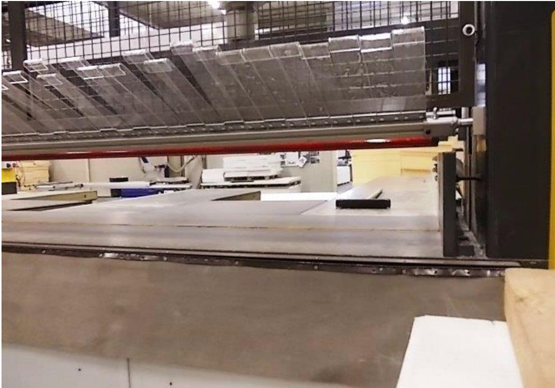
(fig 6.7 - barra rotativa a bandelle per protezione mani)
