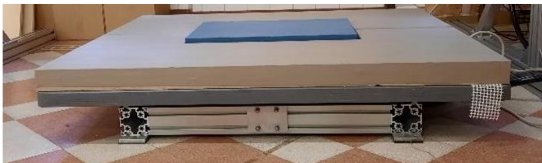
Figura 3.3 Particolare della struttura contenente al suo interno il cilindro elettro attuato che consente il movimento programmato della tavola in legno alla quale è fissata la pedana dinamometrica.
