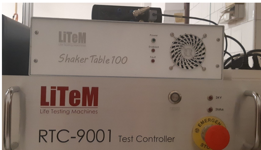
Figura 3.4 Apparecchiatura hardware per il controllo di Shaker Table.
