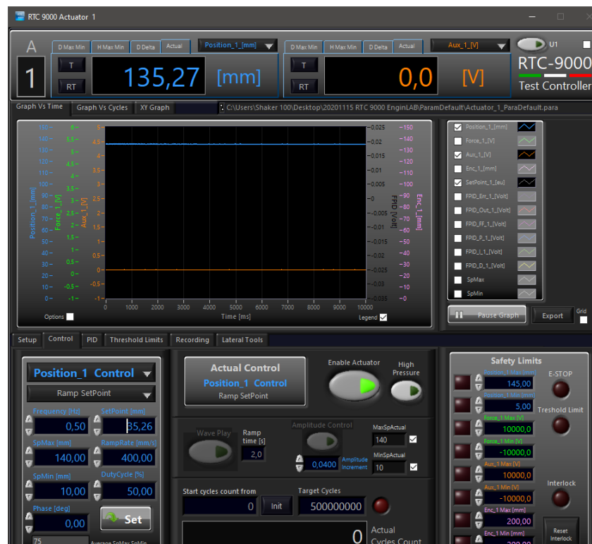
Figura 3.9 Software 2-Axis Dynamic Testing System per l'impostazione dei parametri di spostamento e velocità.
