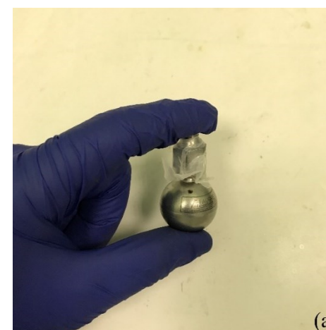
Figura 17: in figura (a), la visione di una cella HEL-HC-4. Il punto nero evidenzia la corrosione della cella porta-campione. In figura (b), la termocoppia legata alla misurazione della temperatura del campione corrosa dalla soluzione al 50% wt di idrossilammina al 2% wt di cloruro di idrossilammina.
