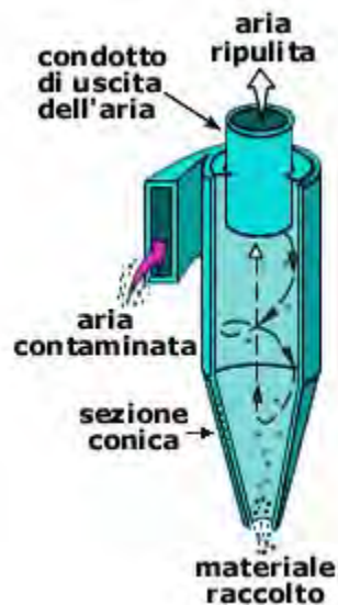
Figura 29 – Filtro multiciclone
