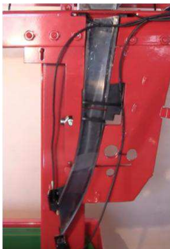
Fig. 3.4 Fotocellule montate sul tubo adduttore.
