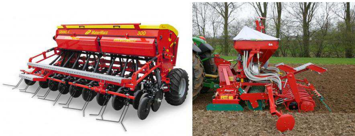
Fig. 2.2 Seminatrice a righe meccanica a sinistra e seminatrice a righe con trasporto pneumatico a destra.
