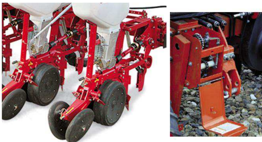
Fig. 2.12 Seminatrice con trasmissione meccanica e scatola del cambio per variare l'intrafila.
