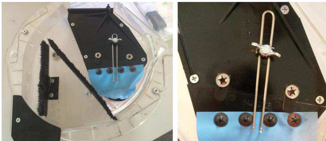
Fig. 3.6 Copridisco con ferretto e film di nylon, a destra particolare del sistema di regolazione della posizione del ferretto.
