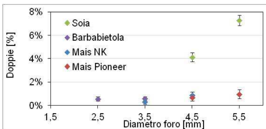
Fig. 3.12 Influenza del diametro del foro sul numero di doppie. I dati sono aggregati per i diversi casi di velocità, di posizioni del ferretto e di azionamento.
