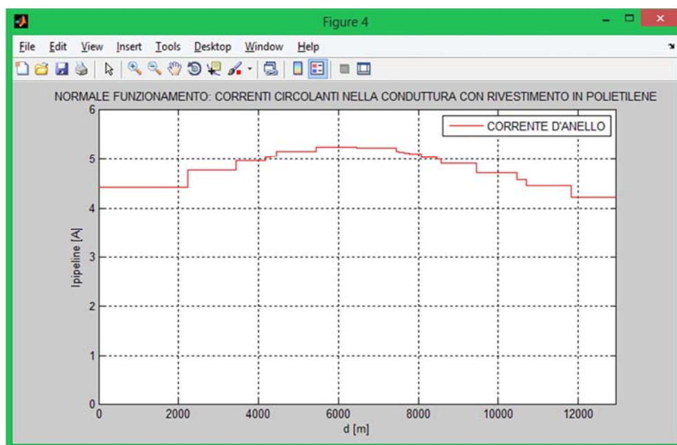
Fig.3.12 - Andamento delle correnti d'anello per normale funzionamento (rivestimento in polietilene).
