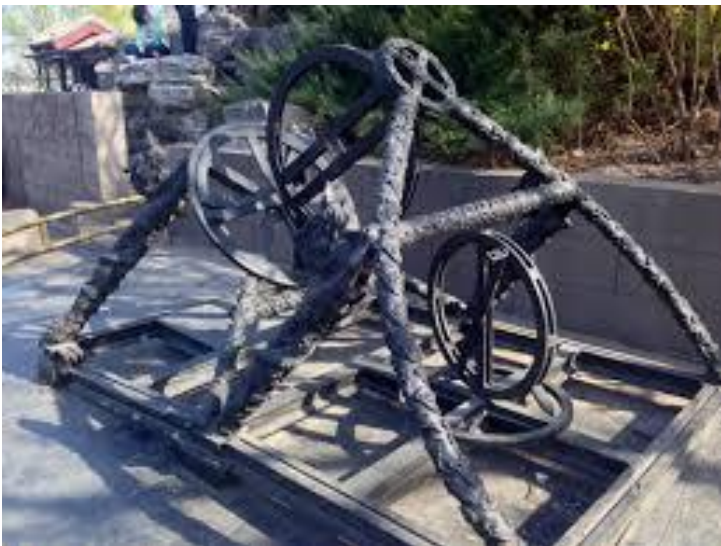
Figura 4 Riproduzione dello strumento semplificato di Guo Shoujing, jian yi . Nella parte superiore si può notare la struttura puntata verso il Polo Nord Celeste, mentre il cerchio in posizione verticale serviva per il calcolo dell'azimut.
