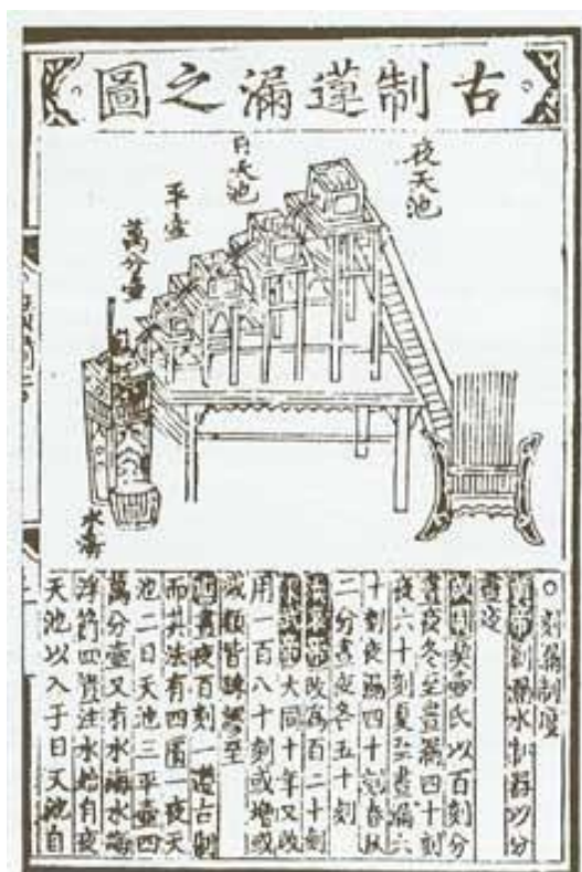
Figura 5 Rappresentazione del XIII-XIV secolo d.C. di una clessidra con plurimi serbatoi ausiliari. Questo tipo di strumento fa parte della categoria: clessidre a deflusso.
