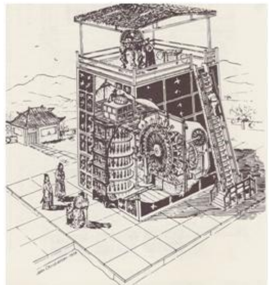
Figura 6 Torre orologio di Kaifeng. In questa illustrazione si può notare il complesso meccanismo che metteva in funzione il globo celeste e la sfera armillare alla sommità della struttura.
