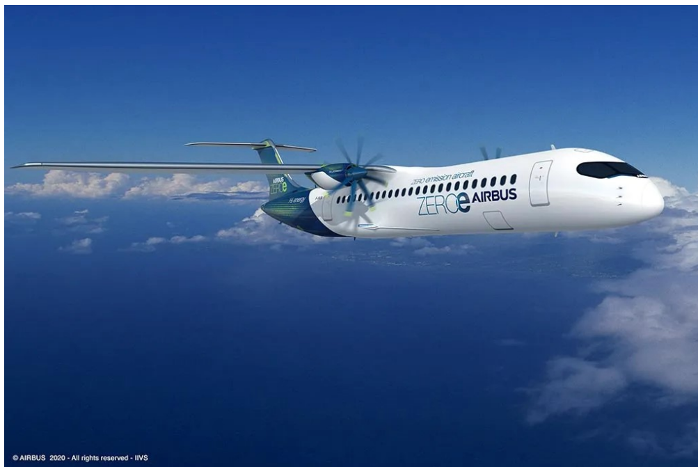
Figura 14 – Turboelica (fino a 100 passeggeri, alimentato dalla combustione dell'idrogeno, per viaggi corti).
