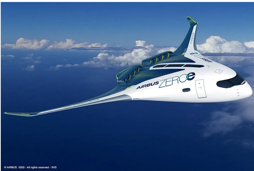
Figura 16 – Jet con ali unite al corpo principale (200 passeggeri), cabina molto spaziosa, consuma 20% in meno di altri aeromobili a idrogeno.
