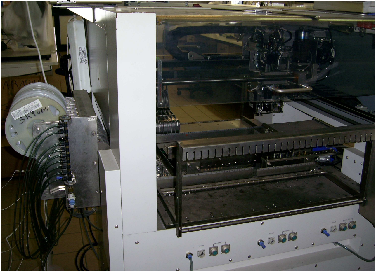
Una macchina pick & place: a sinistra si possono notare i caricatori circolari dei componenti (bobine a nastro continuo della capacità di 10.000 componenti).
