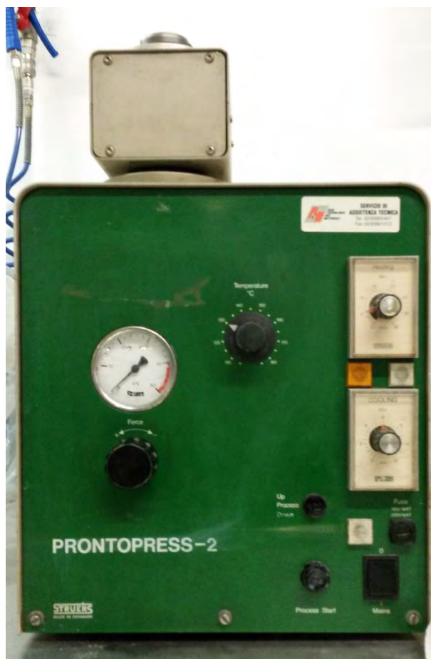
Fig. 2.4: Pressa a caldo Struers Prontopress-2. Sono visibili le regolazioni della temperatura, forza e tempi di riscaldamento-raffreddamento.
