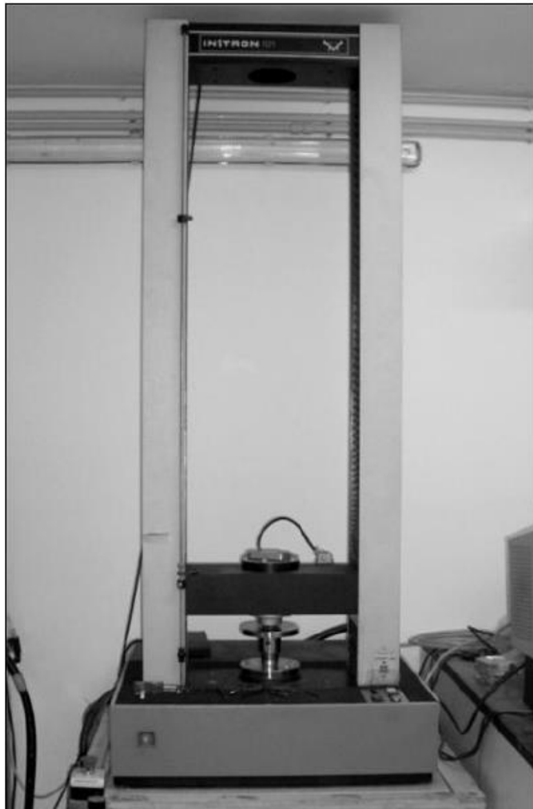
Fig. 5.3: Macchina per prove di compressione Instron 1121 UTM.
