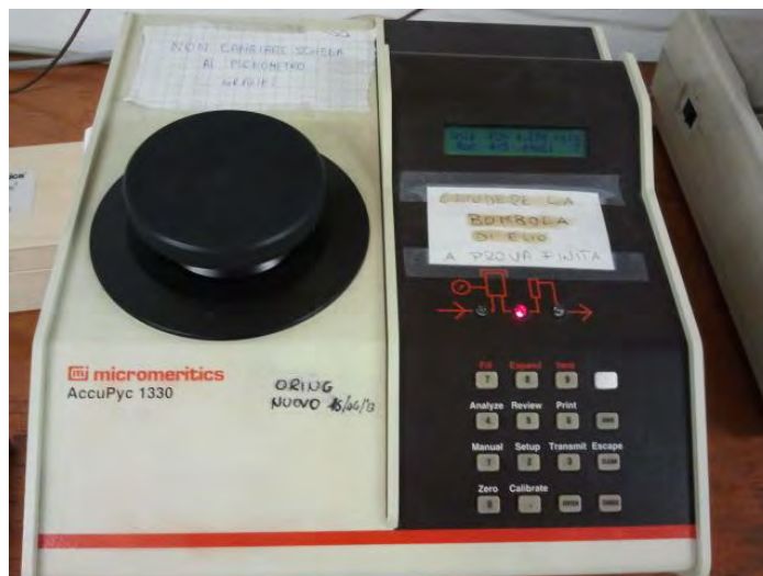
Fig. 5.1: Picnometro AccuPyc usato per le misure di densità.
