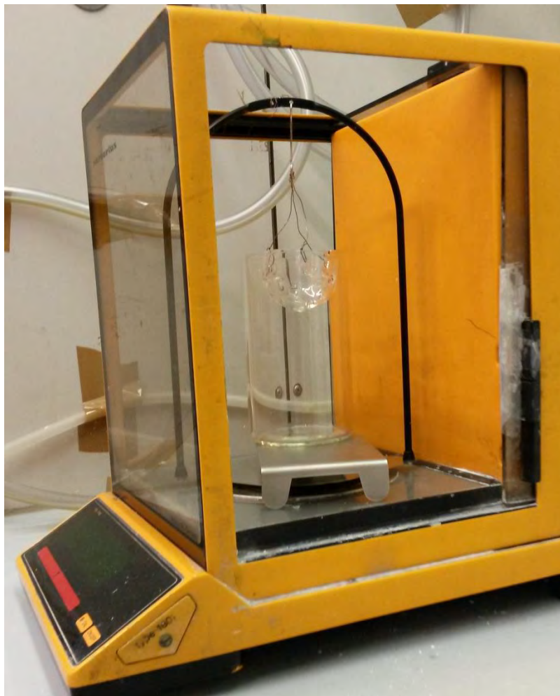
Fig. 5.2: Attrezzatura per misure di densità secondo il metodo di Archimede.
